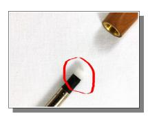
Jetzt können Sie die leere Mine nach unten entfernen. Sie fällt ganz leicht heraus. Achten Sie aber unbedingt darauf, dass die kleine Minenverlängerung (siehe Markierung) nicht verloren geht. Diese Verlängerung setzen Sie auf die neue Minen. Setzen Sie die neue Mine mit der Verlängerung ein und schrauben die Spitze wieder auf.
