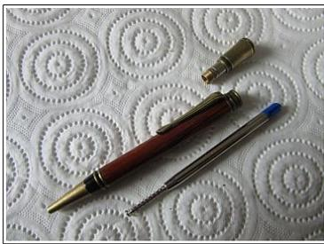
Jetzt können Sie die leere Mine nach oben entfernen. Sie fällt ganz leicht heraus. Nachdem Sie die leere Mine entfernt haben, setzen Sie die neue von oben ein und schrauben die Rändelkappe wieder auf.
